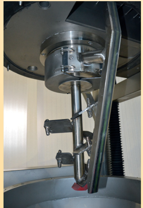
Mischerwerkzeug mit Schnellwechselsystem
