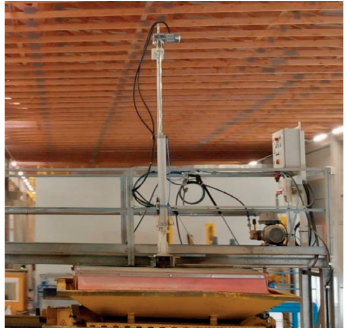
Bei der Reinigung von Betonverteilern wird eine einfahrbare Lanze mit drehendem Reinigungskopf in den zu reinigenden Behälter eingefahren.
