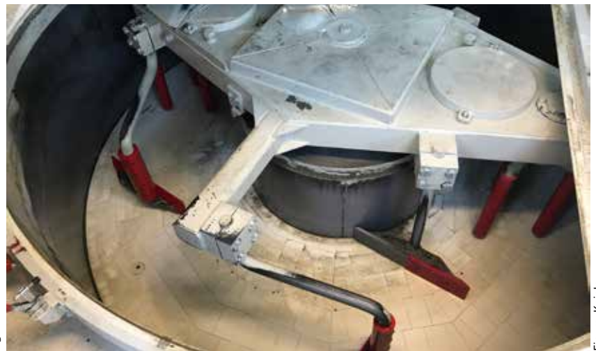
This mixer type was especially designed to ensure homogeneous mix quality Dieser Mischertyp steht für eine homogene Mischqualität
