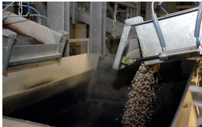
Le dosage exact des granulats dans la balance mobile est effectué au moyen de goulottes vibrantes et de clapets d'arrêt
