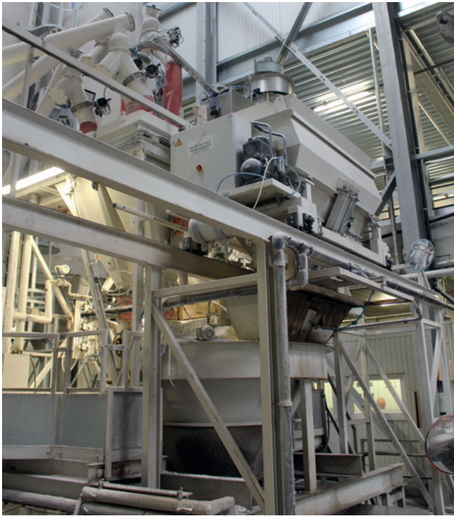
Les granulats sont transportés directement jusqu'au malaxeur, dans lequel la balance est vidée
