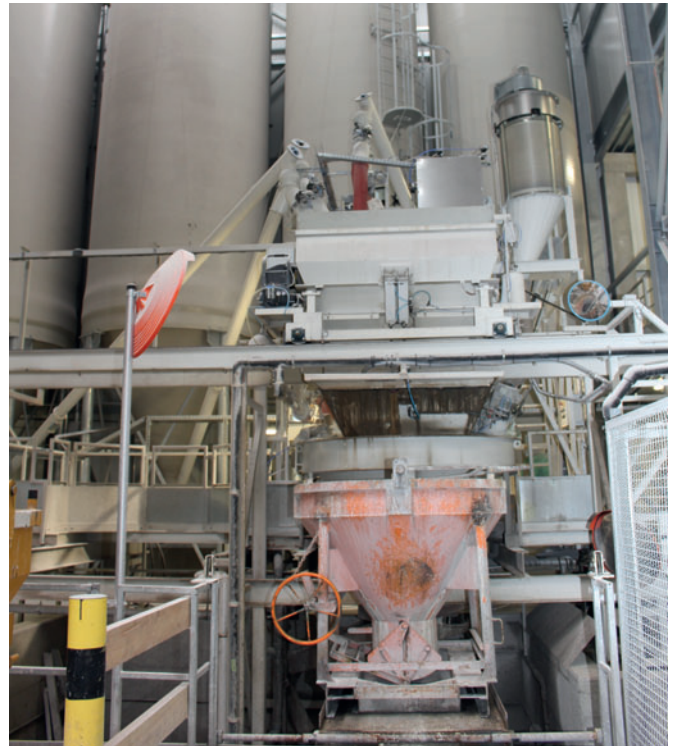
Le malaxeur se vide directement dans une benne à béton, qui est transportée vide jusqu'au malaxeur à béton via une plate-forme élévatrice montée sur un chariot mobile
