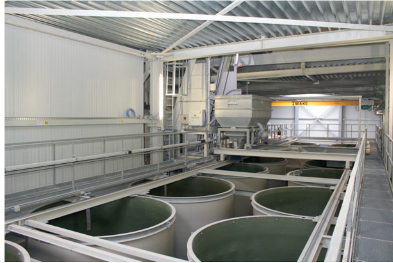
Une fois le niveau supérieur atteint, le transfert des granulats s'effectue dans une benne pouvant être déplacée dans deux directions
