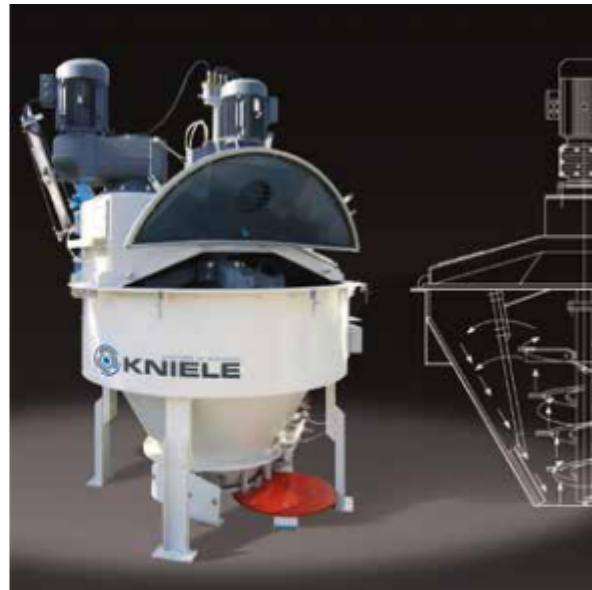
l'axe central et bras périphériques disponibles en inox, ou acier avec revêtement carbure, Hardox ou PU ; et une bande de propreté supérieure en PP de série, avec options céramique ou PE.
